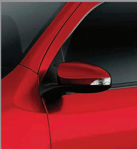
Espejos exteriores con luz de giro incorporada y regulación eléctrica.<sup>1</sup>
